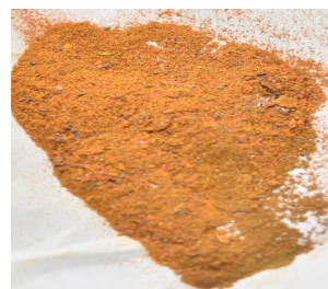
Рис. 6. Вид части расплавленной, испаренной и кристаллизованной на поверхности серы и мышьяка в соединении с окислами железа после 90 мин обработки ВЧ ЭМВ руды «Кокпатас»
