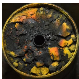
Рис. 5. Вид пробы флотоконцентрата руд «Кокпатас», после 60 минутной обработки ВЧ ЭМВ
