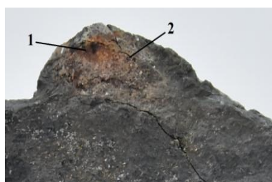
Рис. 4. Вид куска руды месторождения «Кокпатас» после 30 минутной обработки ВЧ ЭМВ: 1 – арсенипирит; 2 – пирит
